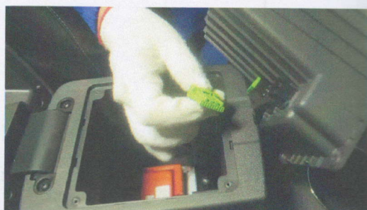
图 3-2-11 拆卸储物盒线束插接器
