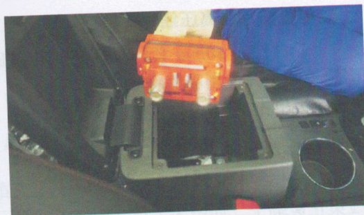
图 3-2-13 断开维修开关
