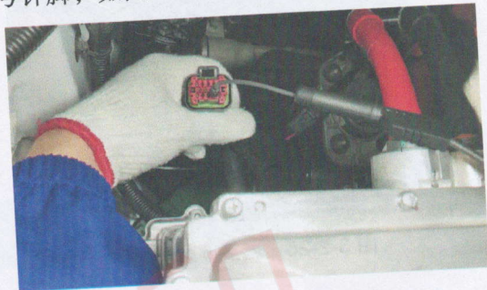
图 3-2-22 连接 11 号针脚
