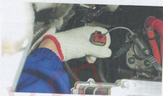
图 3-2-26 连接 8 号针脚
