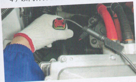
图 3-2-21 连接 10 号针脚
