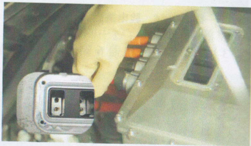
图 3-2-20 负、正极电机控制器高压母线安装
