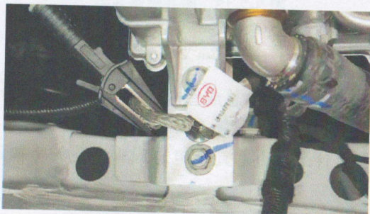
图 3-2-18 数字兆欧表黑笔连接搭铁
